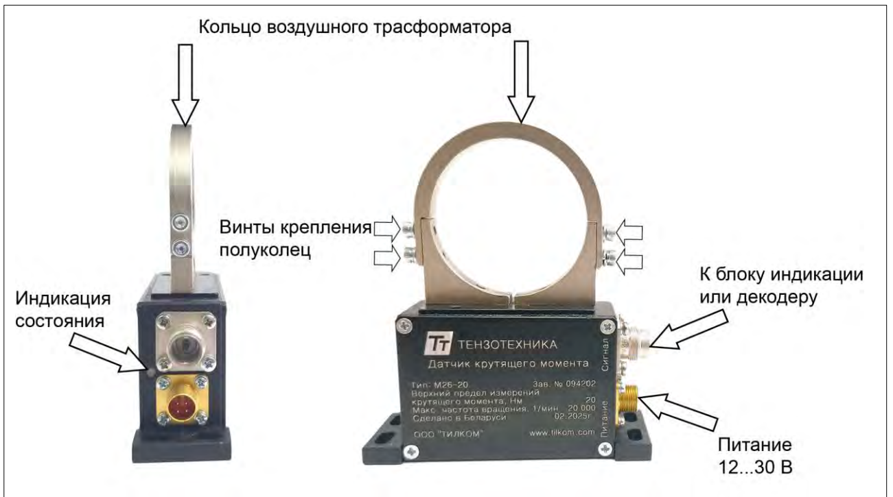
Рис. 3 – Статор датчика M40A
