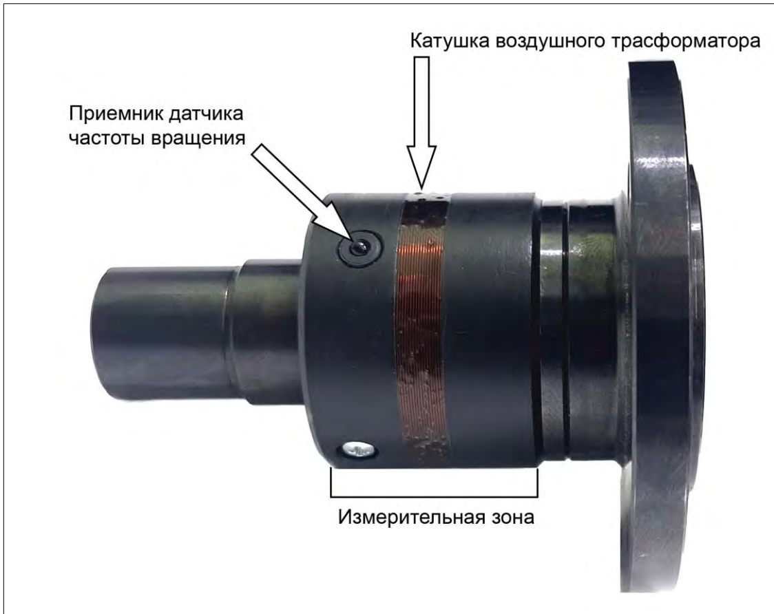
Рис. 2 – Ротор датчика M40A
